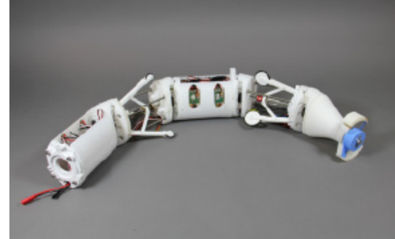
Prototype van een autonome inspectierobot (AIR) die langdurig in het leidingnet verblijft en de toestand en positie van kleinere leidingen in kaart brengt.
