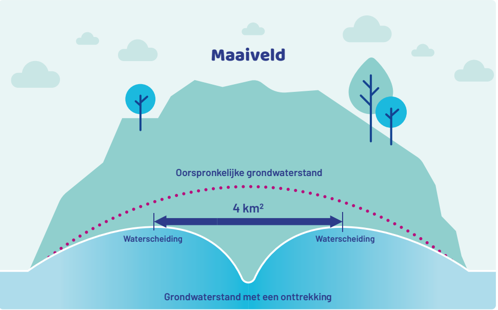
Figuur 33. Effect van een grondwateronttrekking op het plateau.
