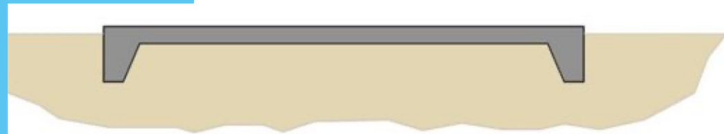
Betonnen plaat met 'vorstrand'
