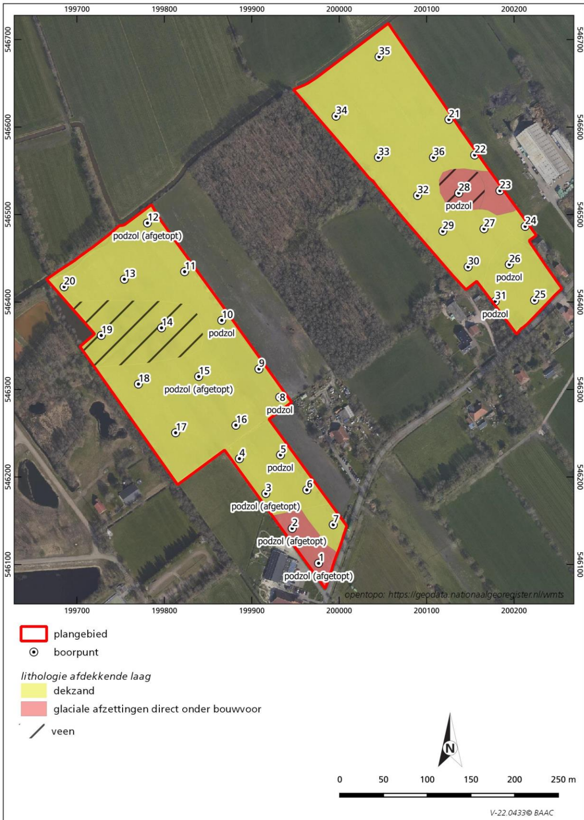
Afb. 3.4 Boorresultatenkaart met de aangetroffen lithologie van de bovenlaag.
